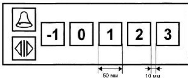
Рисунок G.2 – Пример однорядного расположения квадратных кнопок
