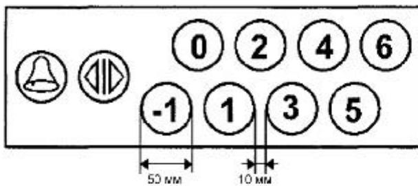
Рисунок G.3 – Пример двухрядного расположения круглых кнопок
