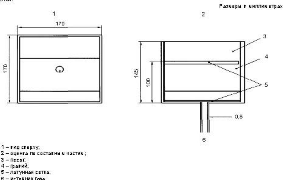
Рисунок С.1 – Пример стандартной калибровочной горелки
