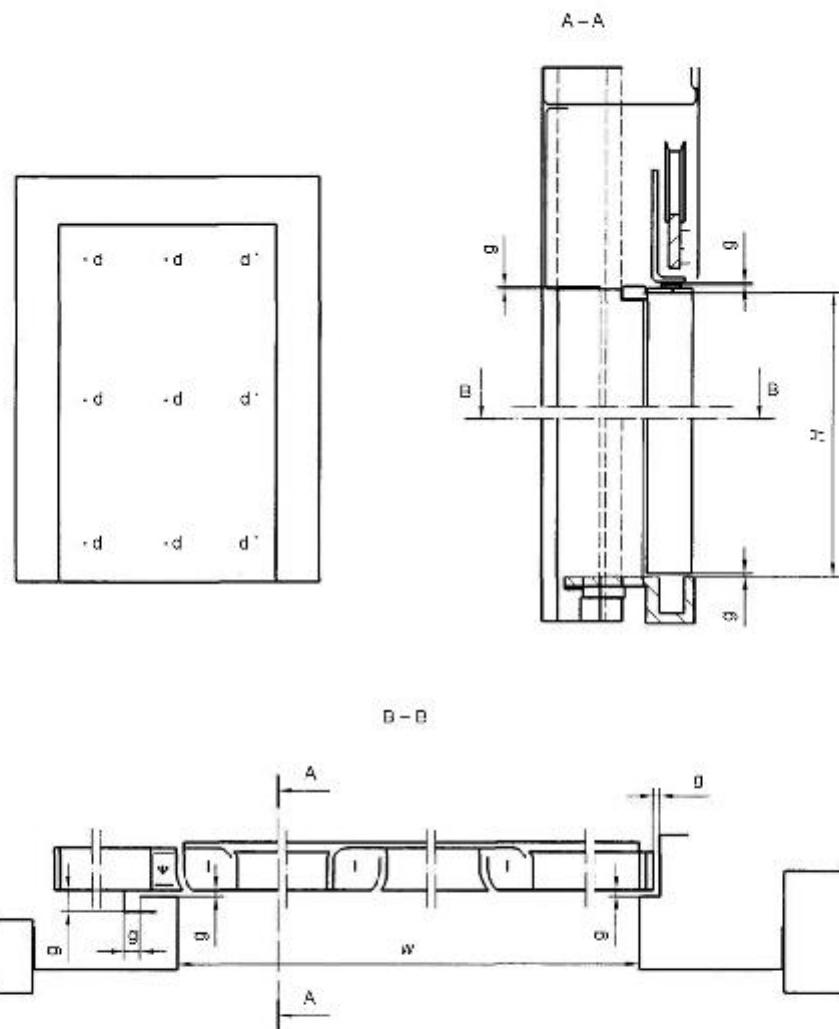
g – Места измерения зазора;
